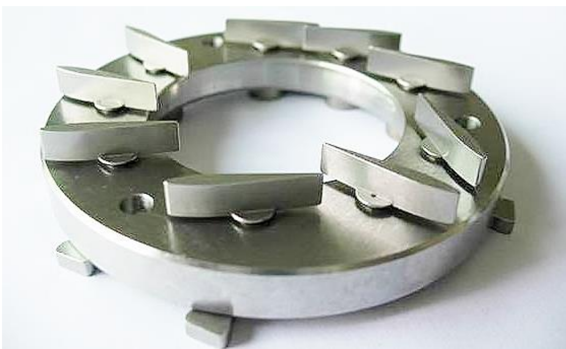
Obr. 2: Pohyblivé lopatky VNT turbodúchadla [3]
