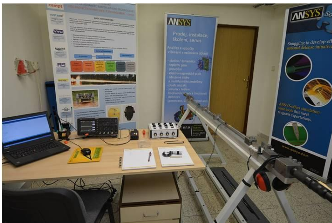
Obr. 2: Pracoviště, kde je prováděn test Hopkinsonovy dělené tyče
